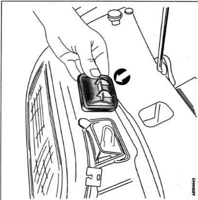
Рис. 22. Замена лампы фары-прожектора
