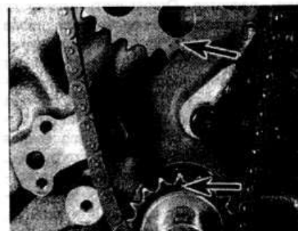
Рис. 2.122. Совмещение меток на звездочках цепного привода распределительного вала (метки показаны стрелками)
