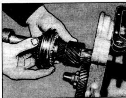
Рис. 4.13. Снятие синхронизатора и шестерни V передачи
