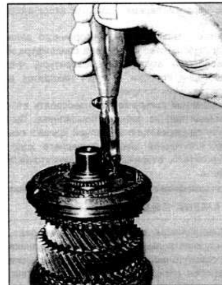
Рис. 4.42. Снятие стопорного кольца ступицы синхронизатора III и IV передач
