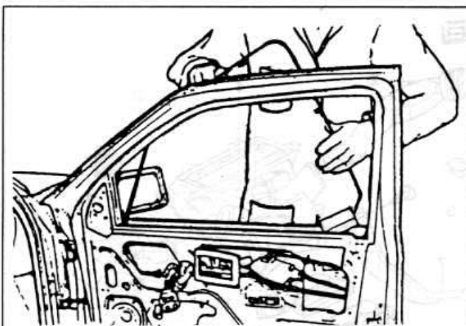
Рис. 9.49. Снятие опускного стекла передней двери
